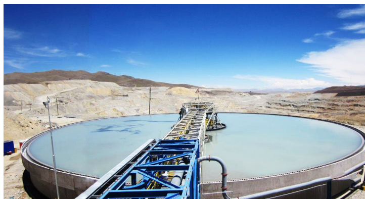
Um Espessador DELKOR de Alta Densidade instalado no Peru com 60 m de diâmetro, semelhante ao equipamento que está sendo fornecido para Talabre.
