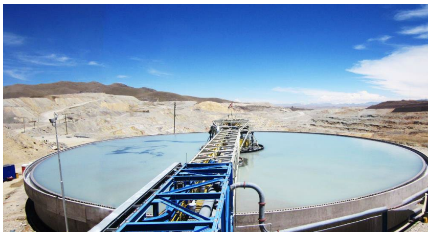
Espesador de alta densidad DELKOR (Perú) similar al equipo suministrado para Talabre.
