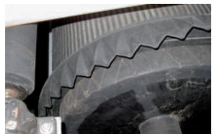
Originalmente se utilizaron bordes rectos en todos los tamaños de filtro, pero el rápido deterioro que sufrían debido al estiramiento conllevó el desarrollo de un borde más rentable por parte de DELKOR en 1983. Esta importante innovación, el borde ondulado o curbing de DELKOR, proporcionó un sellado al vacío y un ciclo de vida superior, y hoy en día es utilizado por todos los fabricantes de filtros de banda, que reconocen sus cualidades únicas.
