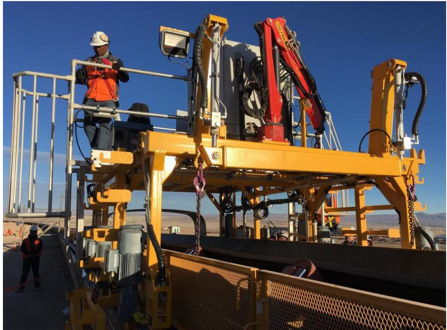
*Bild 11: TAKRAF Servicefahrzeug zum Ausheben des Gurtes und zum Tragrollenwechsel*
