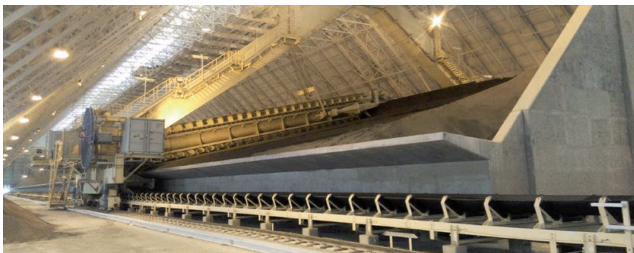
Фото выше: порталный кратцер-кран на складе фосфатов, ширина колеи 51,7 м, производительность 2000 т/ч
