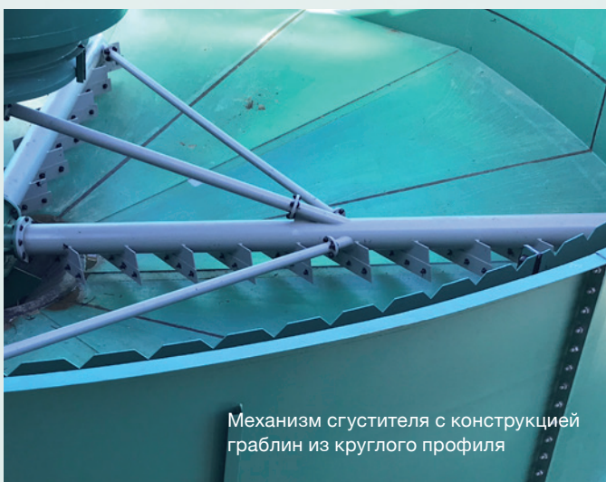
60 м секционный сгуститель с болтовым креплением во Вьетнаме
